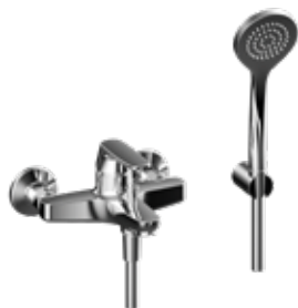
Miscelatore da bagno ProCasa Uno D 153 mm, raccordi d'arresto 1/2" x 3/4", tubo da doccia, doccia a mano, supporto, gruppo acustico I
